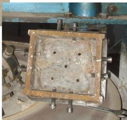
La presión que indica la norma para el ensayo produce el frenado de la pista, vibraciones y rotura de ejemplares de ensayo, por lo que la misma debió ser disminuida a más de la mitad. Se construyó un nuevo sistema de mordazas para evitar el tallado del adoquín, exigido por la norma, pudiendo utilizarse  $\frac{1}{2}$  adoquín para el ensayo. Se propone tomar 1000m de recorrido en la pista de desgaste, en vez de 4000m como indica la norma, disminuyendo el límite de desgaste a 2.4 mm.
